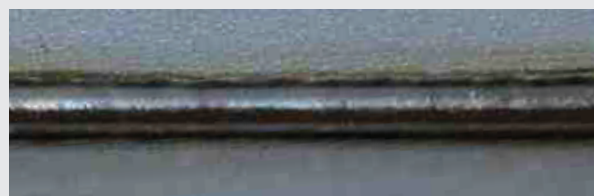
Edelstahl, handgeschweißt, Speed-Puls, geringe Wärmebringung, Sinus – höhere Wärmebringung Hand weld of Stainless steel, speed-puls, small heat affecting zone, sinus – higher heat in
