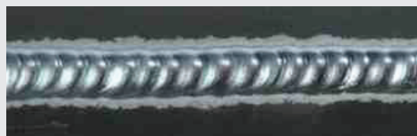
Aluminium, handgeschweißt, sehr gute Reinigungswirkung, exakte Lichtbogenführung Hand weld of aluminium, perfect cleaning effect, Stable and exact handle of the arc
